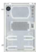
41002 Áudio, teleloop para próteses auditivas, 1 entrada para câmara e 4 botões
